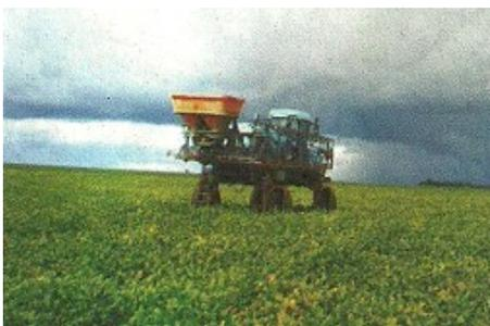
Figura 01: Adaptação no autopropelido para aplicação de milho no rastro do pulverizador
